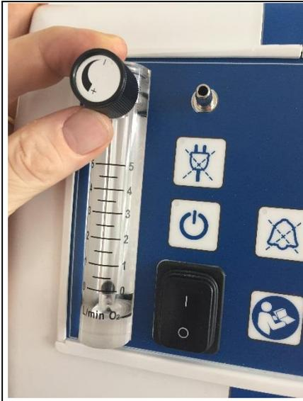
**1 Durch Drehen des Einstellreglers wird der Volumenstrom verändert.**
